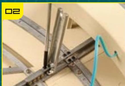
Совместите отверстия в суппорте с отверстиями в каркасе и закрутите в них крепежные винты.
